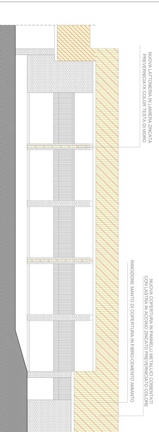
SEZIONE - PROSPETTO HH - STATO DI PROGETTO - INDICAZIONE LAVORI DA REALIZZARE - scala 1:100
